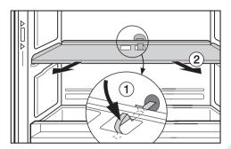
■ Нажмите на фиксатор, расположенный сзади под полкой ①, и вытащите полку вперед ②.
