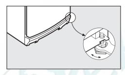
Выровняйте холодильник, поворачивая ножки с помощью прилагаемого гаечного ключа.
